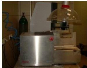
Wyłaczarka dwuślimakowa MINILAB II firmy HAAKE,
